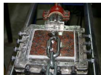
Φωτογραφίες από τις δοκιμές αντοχής των ιταλών. Τα αποτελέσματα είναι καλά, αλλά το βύσμα δεν είναι επίσημα πιστοποιημένο.
